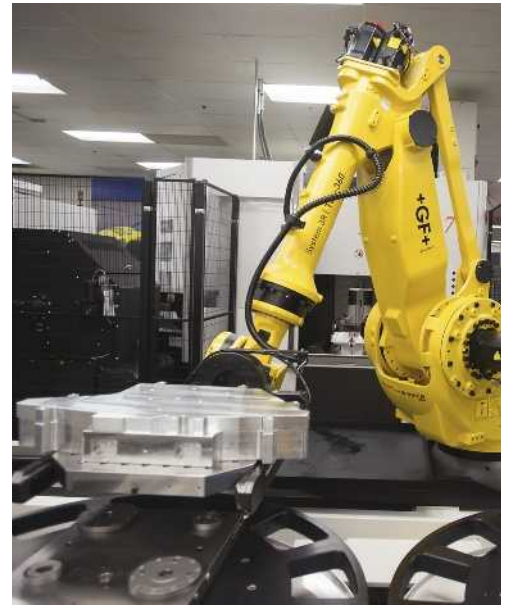
Ein Roboter belädt die Maschinen von mehr als 100 offenen Paletten.
