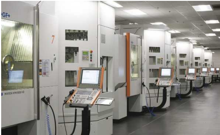
TRD betreibt insgesamt acht GF Maschinen: In einer voll automatisierten Produktionszelle werden Motorblöcke, Zylinderköpfe, Kolben und andere Motorkomponenten von 5-Achsen-Bearbeitungszentren gefräst.
